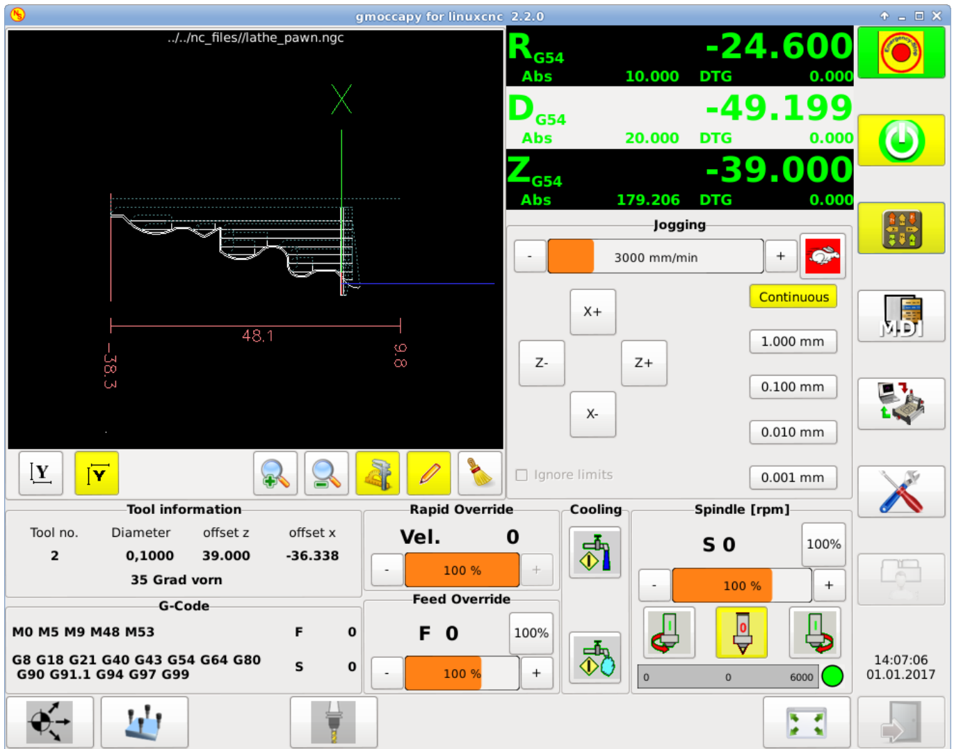
Figura 4.19: Torno con herramienta trasera
