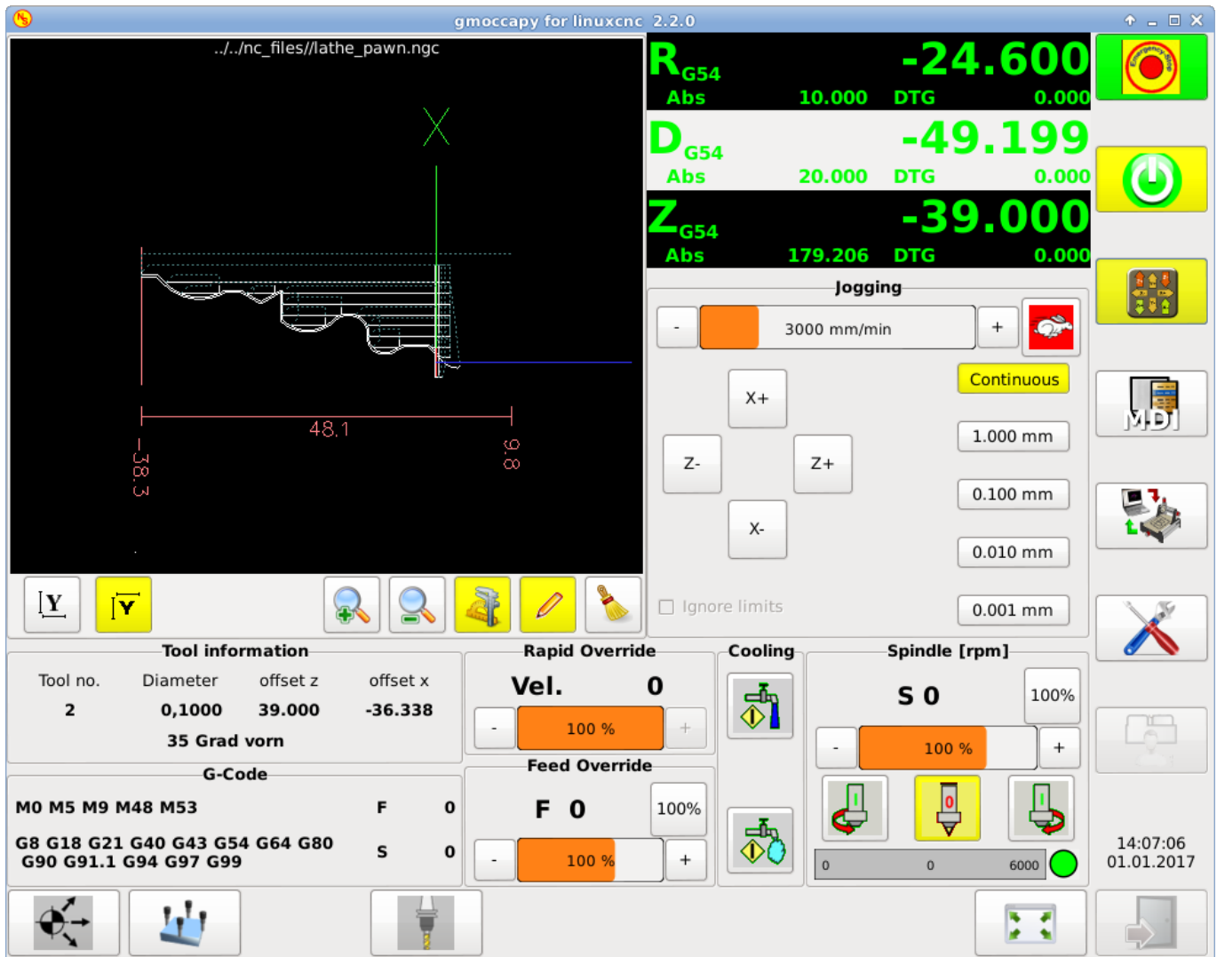
Figura 4.19: Torno con herramienta trasera
