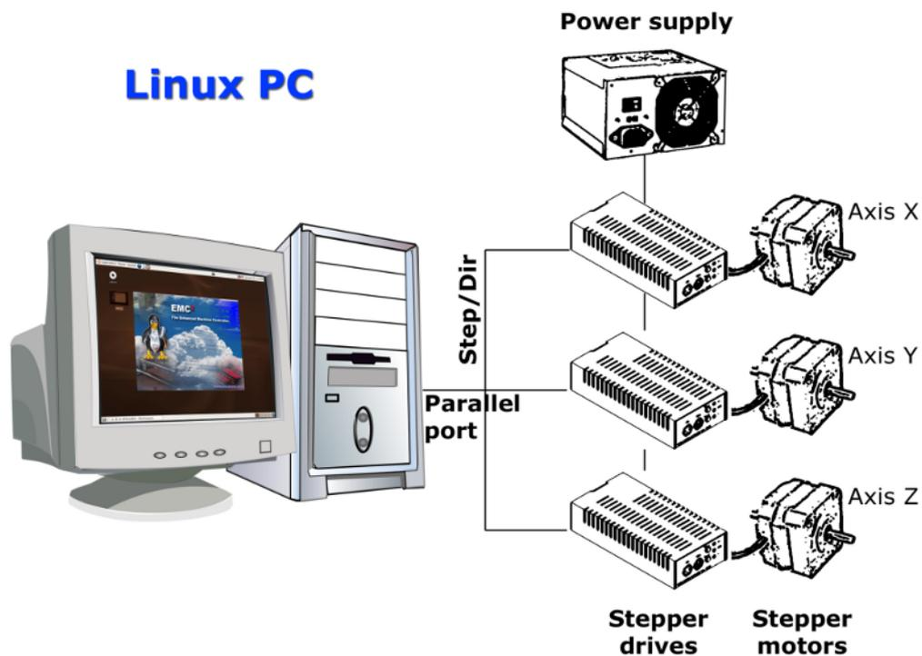
FIGURE 2.1 – Machine simple contrôlée par LinuxCNC
