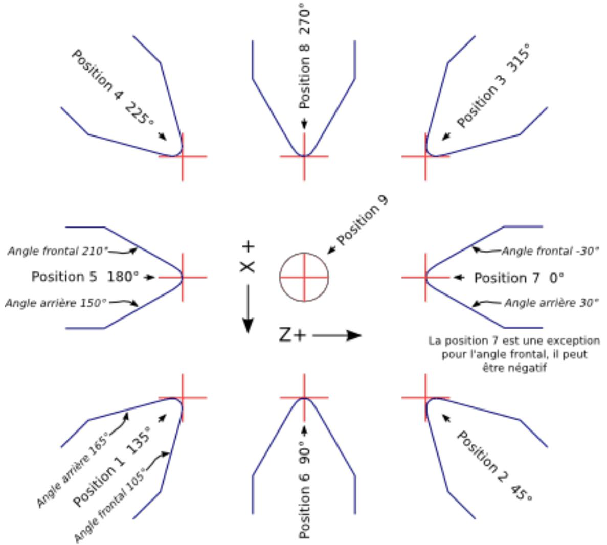
FIGURE 20.1 – Orientations des outils de tournage
