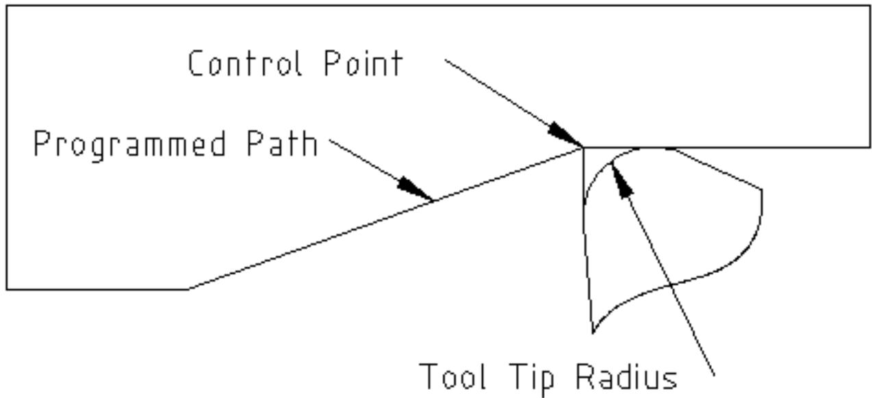
FIGURE 20.3 – Tournage en rampe
