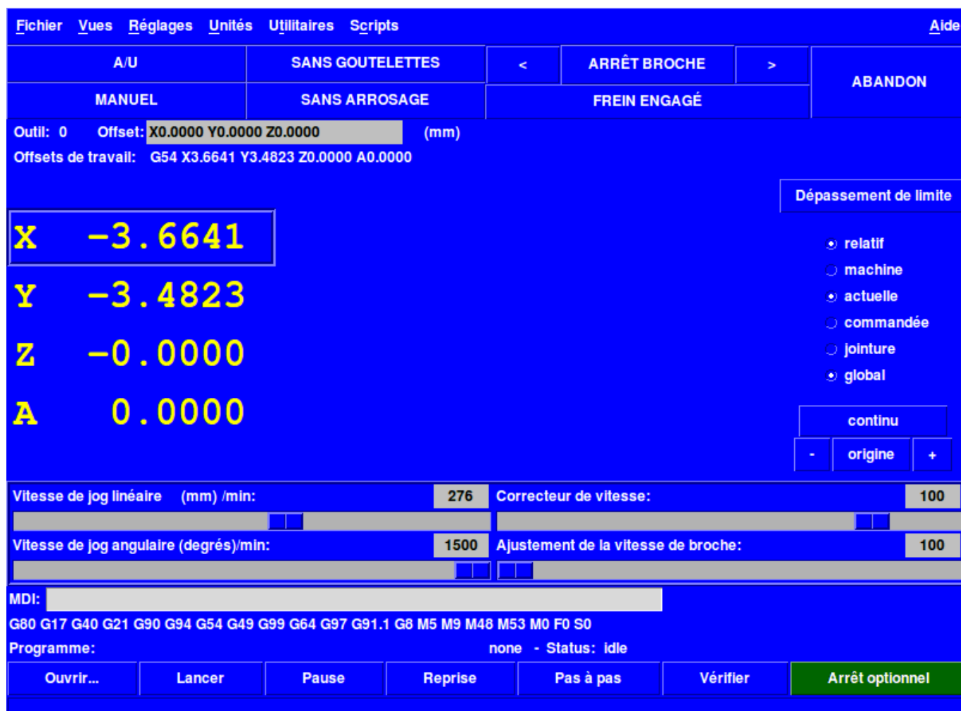
FIGURE 6.1 – L’affichage de TkLinuxCNC
