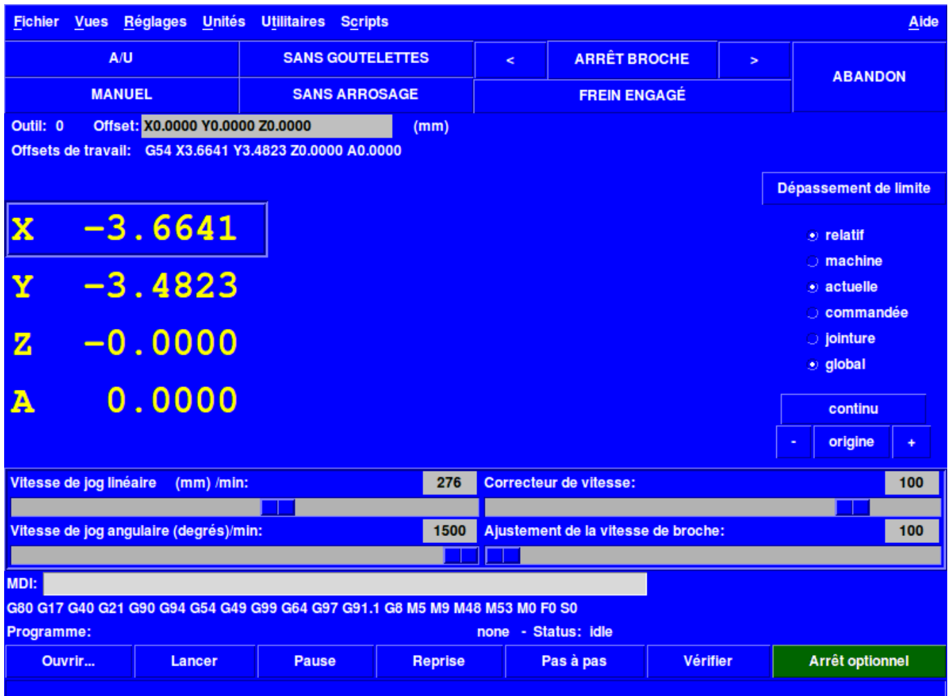
FIGURE 6.1 – L’affichage de TkLinuxCNC
